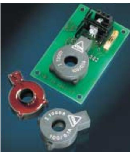
Bild 44: Strommessmodul
